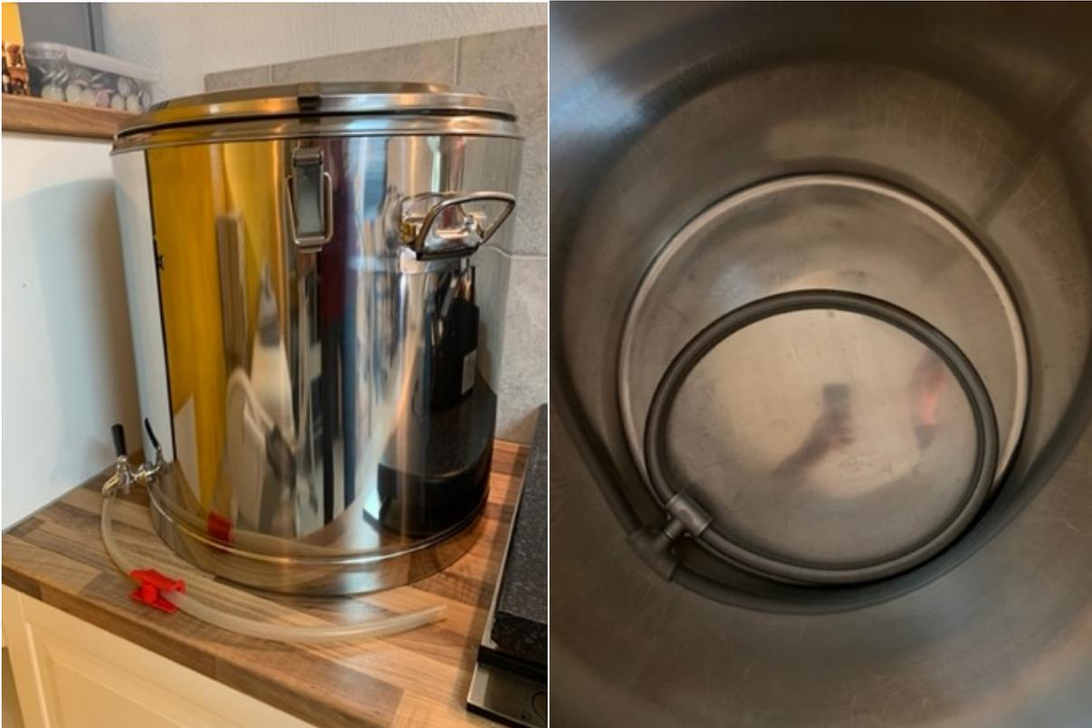
Isolierter Läuterbottich zum Abläutern der Maische, inkl. Läuterhexe (Foto rechts), Ablasshahn und Deckel / Edelstahl / H = 50 cm / Durchmesser = 50 cm
