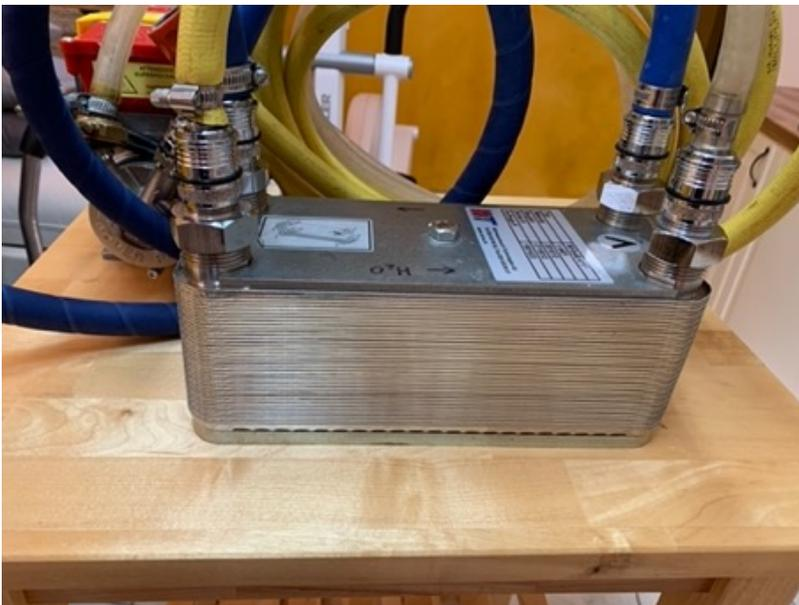
Plattentaucher V4A, ca. 60 kW Kühlleistung, geeignet zum Kühlen mit Netzwasser inkl. Lebensmittelschläuche beim Bierkreislauf
